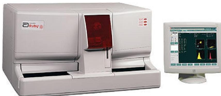
El sistema CELL-DYN Ruby está diseñado para efectuar mediciones en sangre anticoagulada con EDTA y comunicar los siguientes parámetros hematológicos:
