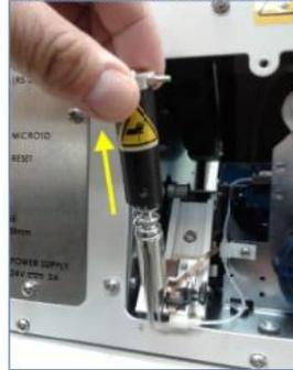
7. Manualmente sacar el cilindro metálico del tubo, girándolo.
